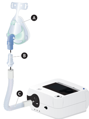
Abbildung 12: Systemaufbau nicht-invasive Beatmung mit non-vented Maske
