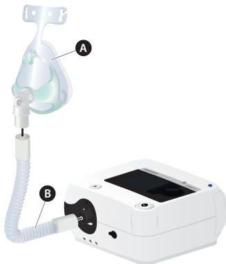
Abbildung 11: Systemaufbau nicht-invasive Beatmung mit vented Maske
